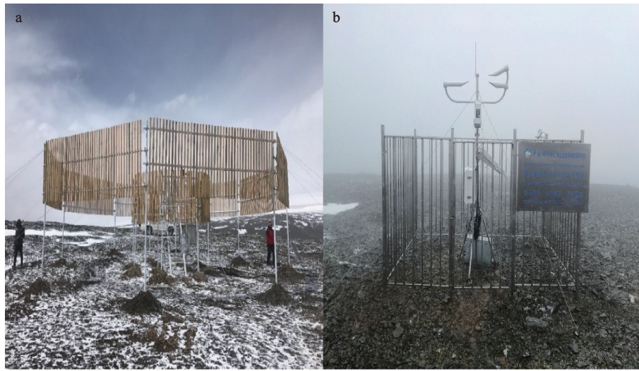
图2 八一冰川地区布设的DFIR双层防风栅栏(a)和PWS100天气现象仪(b)
