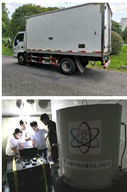
图 4 野外车载绝对重力测量现场照片 Fig. 4. Photos of field measurement of absolute gravity on a truck.
