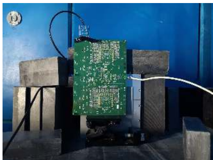
图 1 实验现场图 (中子束流孔道位于测试板背后, 中子束流对准被测器件)
