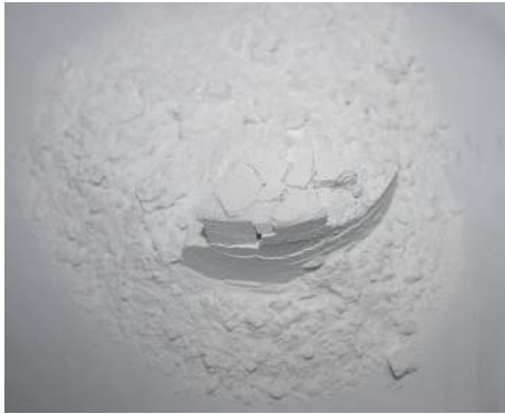
图 8 集粉箱内的粉末压实现象 Fig. 8. Compacted powder in collection box.
