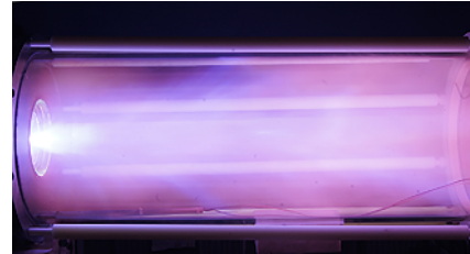
图 5 7 kV 氩气负脉冲放电原图
