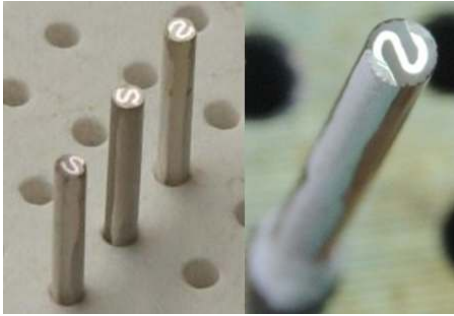
图 1 \Phi 2 mm 柱状热流传感器
