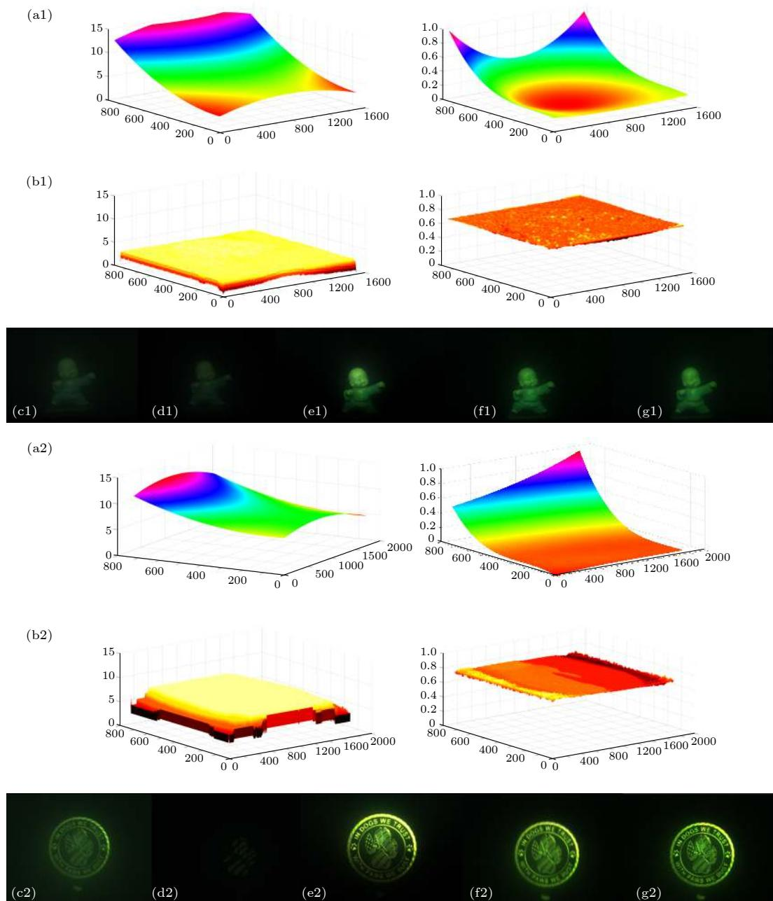
图2 模拟浑浊水下目标图像恢复结果对比, 其中上图为玩偶图像恢复结果; 下图为金属币图像恢复结果 (a1), (a2) 拟合法估计的偏振度分布和背景散射; (b1), (b2) 重聚焦估计的偏振度分布和背景散射; (c1), (c2) 水平偏振图像; (d1), (d2) 垂直偏振图像; (e1), (e2) 拟合法恢复图像; (f1), (f2) 参考视角恢复图像; (g1), (g2) 多视角融合恢复图像
