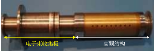
图 14 速调型相对论返波管外观
