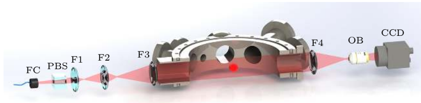
图 1 成像光路示意图. 其中符号的含义为 FC: 光纤耦合头, PBS: 偏振分束器, F1—F4: 透镜, OB: 5\times 成像物镜, CCD: 电荷耦合器件.
