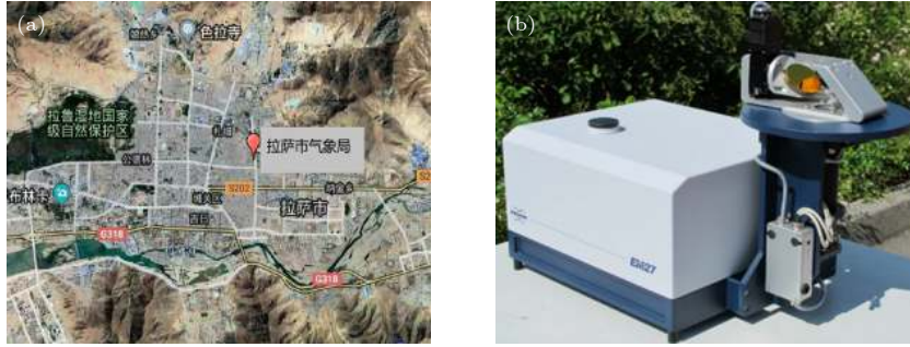
图 1 (a) 观测站点位置 (拉萨市气象局); (b) 观测设备 (傅里叶变换光谱仪, EM27/SUN) Fig. 1. (a) Observing site (Lhasa meteorological bureau); (b) FTIR spectrometer (EM27/SUN).
