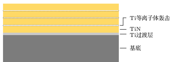
图 2 厚 TiN 涂层的制备工艺示意图
