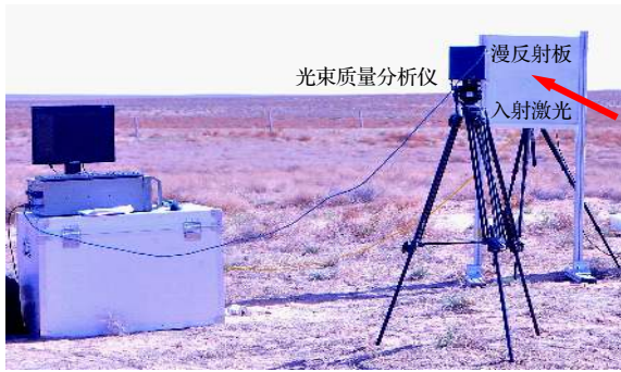
图 9 目标端设备实物 Fig. 9. Equipment at target.
