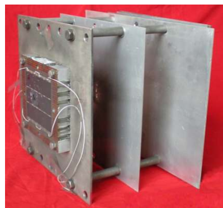
图 2 超高速撞击试件照片
