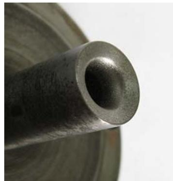
图 9 实验后的内磁极刻蚀形貌图
