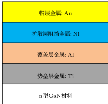
图 1 目前最常应用于 n 型 GaN 欧姆接触的 Ti 基多层金属体系
