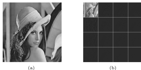
图 1 Lena 图像及其二阶小波包变换 (a) 原图; (b) 二阶小波包变换
