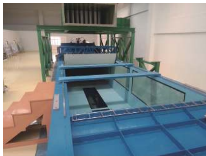
图1 循环水槽试验段示意图
