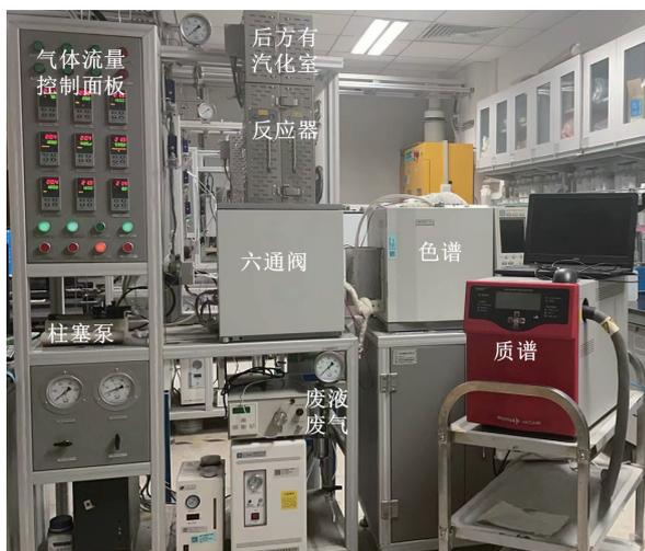
图 1 固定床反应器实物图
