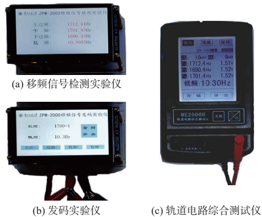
图 13 检测仪检测验证硬件环境图
