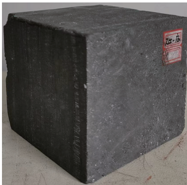
图 5 100\text{ mm} \times 100\text{ mm} \times 100\text{ mm} 煤岩立方体试件
