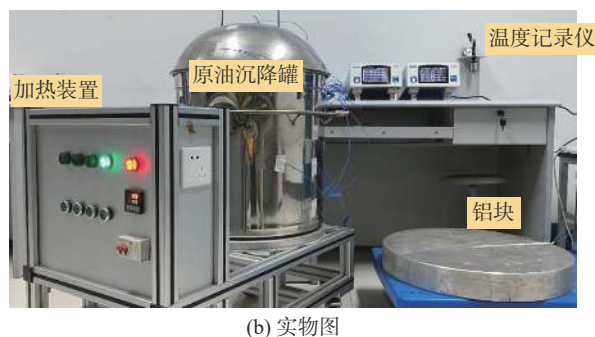
图 1 原油沉降罐模拟实验系统装置图
