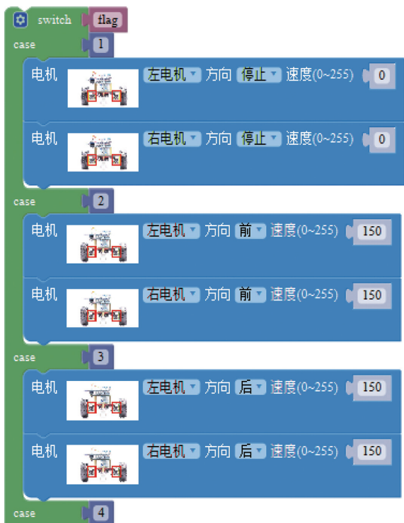
图 6 小车的分支运动控制程序的 Mixly 代码实现
