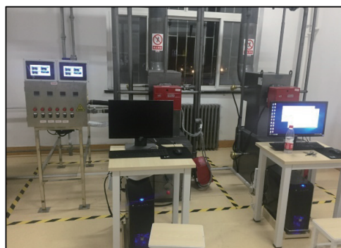
图6 垃圾焚烧半实物装置
