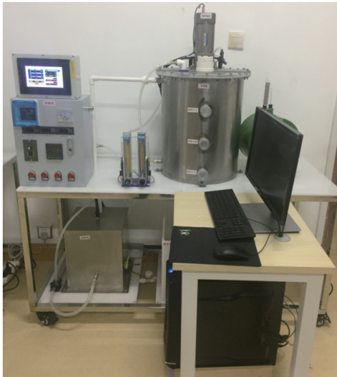
图 2 堆肥系统半实物装置 (长×宽×高: 1.5 m×0.5 m×1.5 m)
