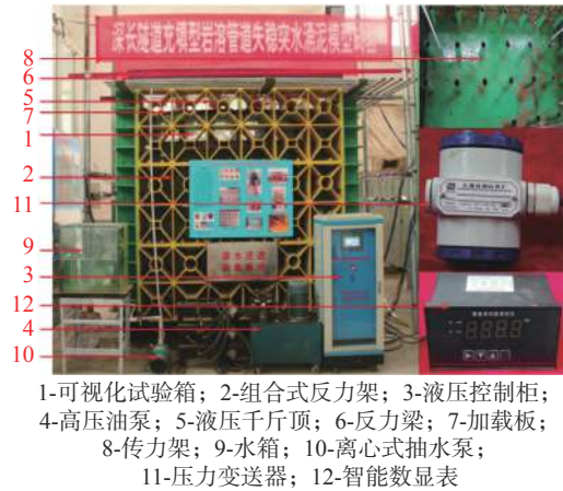
图 2 大型地质力学模型试验装置
