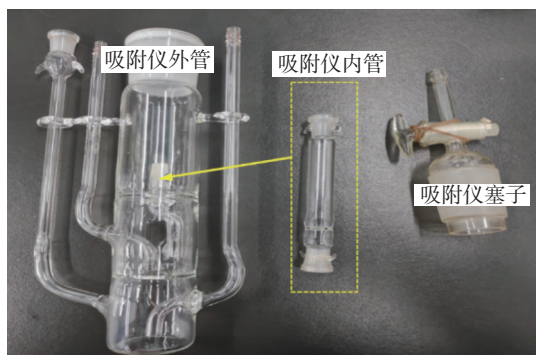
图2 原有实验的吸附仪实物照片 (称量过程中需单独取出吸附仪内管进行称重)
