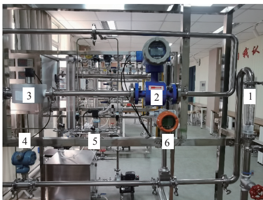
1—浮子流量计; 2—电磁流量计; 3—罗茨流量计; 4—涡轮流量计; 5—节流孔板; 6—涡街流量计。
