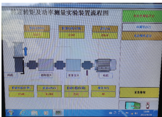
图 6 转速、转矩及功率数据采集界面
