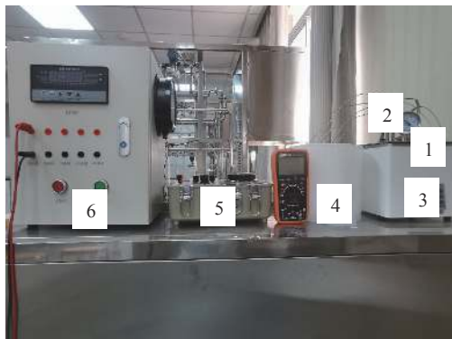
1—高精度标准水银温度计；2—各种型式的温度计；3—恒温水槽；4—冰点槽；5—直流电位差计；6—温度巡检仪
