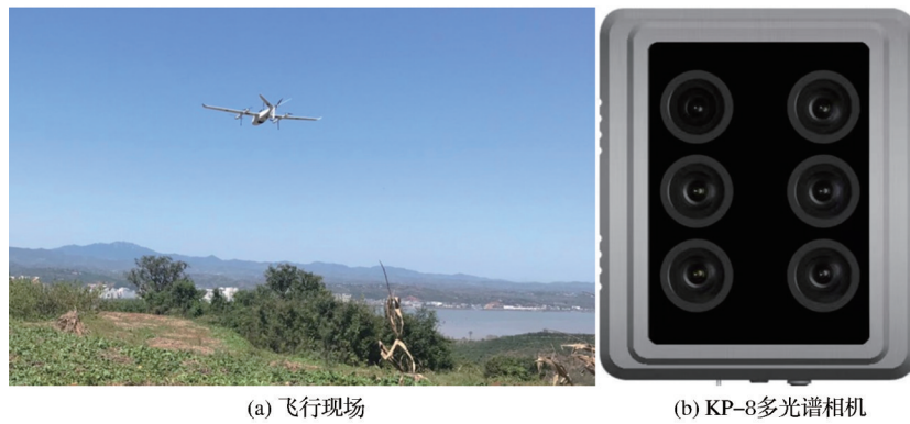
图1 垂直起降固定翼飞机搭载KP-8多光谱相机飞行实验
