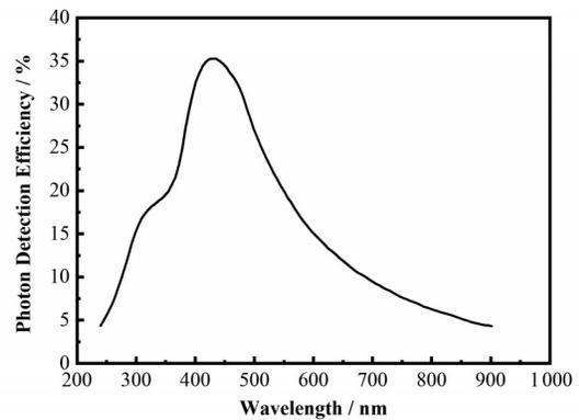
图6 光子波长与探测效率的关系
