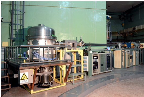
图1 基于北京 HI-13 串列加速器的重离子单粒子效应专用辐照装置
