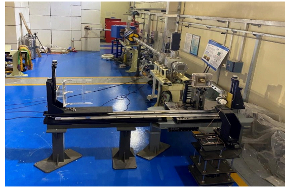
图2 基于100 MeV质子回旋加速器的质子单粒子效应模拟试验装置
