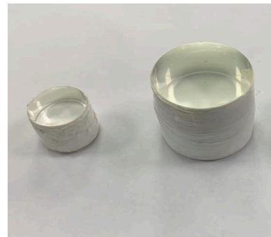
图 1 自研 \phi 2.54 \text{ cm} \times 2.54 \text{ cm} 和 \phi 5.08 \text{ cm} \times 5.08 \text{ cm} 塑料闪烁体拍照
