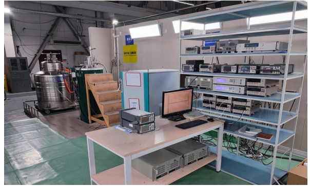
图 6 低温测试平台 Fig.6 Snapshot of cryogenic test platform
