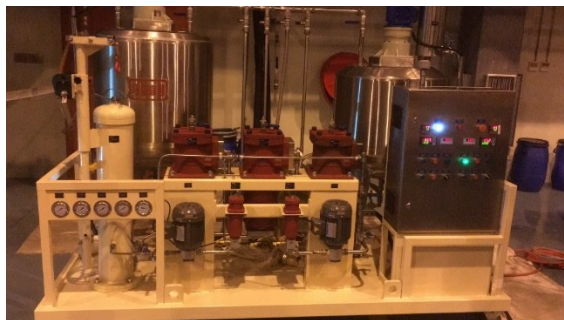
图 2 放射性废油核素分离净化处理实验装置
