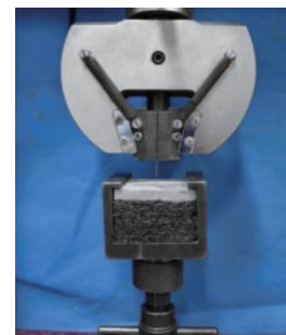
图2 钢纤维拉拔试验图
