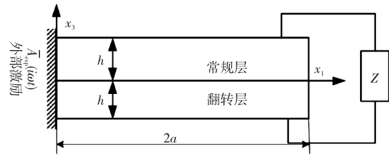
图 3 悬臂梁压电俘能器
