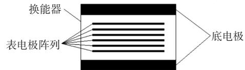
图2 表电极图形
