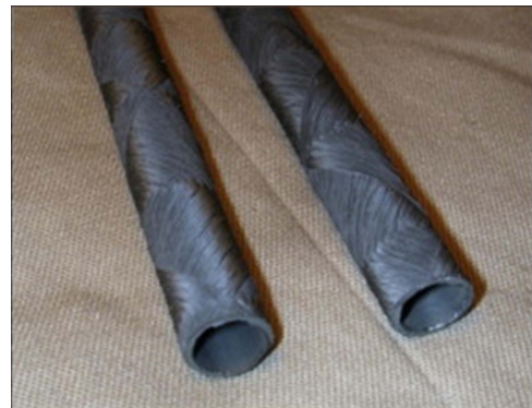
图 10 西屋双层 SiC 包壳管 [103]
