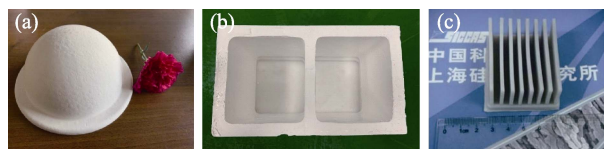
图 15 自发凝固成型制备复杂形状氧化铝半球状部件(a)、氧化铝导轨(b)以及氮化铝部件(c)
