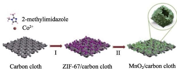
图 1 在碳布上两步合成 \text{MnO}_2 空心多面体纳米结构的制备过程示意图 [13]
