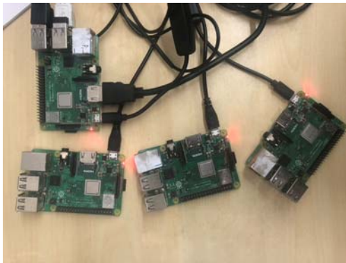
Fig.6 Raspberry Pi testbed 图 6 树莓派测试平台
