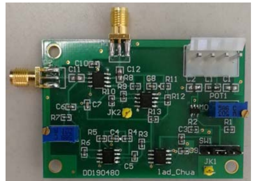
Fig.8 PCB photo of Riordan analog inductor circuit 图 8 里奥登模拟电感电路 PCB 照片
