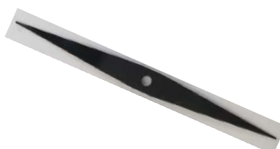
Fig.13 Attenuation slice 图 13 衰减片实物图
