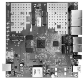
Fig.3 Qualcomm IPQ806x wireless node 图3 高通 IPQ806x 无线节点方案
