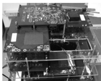
Fig.2 Cascading multiple samples test system 图 2 层叠式多样品测试系统
