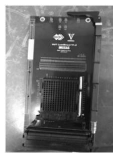
Fig.5 Loading board of the DUT 图 5 被测器件装载板
