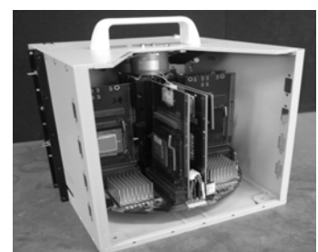
Fig.3 Rotating vertical test system 图 3 旋转立体结构测试系统
