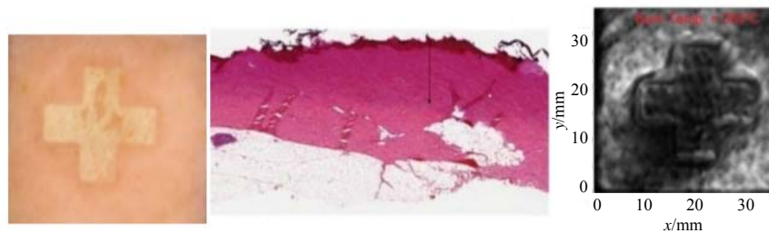
Fig.4 Visible pictures (left), H&E stained section (middle) and THz image (right) of pork skin 图 4 猪皮组织的可见光图片(左)、H&E 组织染色部分(中)和太赫兹成像图片(右)
