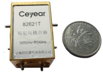
Fig.5 Directional coupler 图 5 定向耦合器
