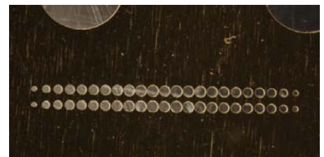
Fig.4 Sheetmetal for coupling 图 4 耦合片实物
