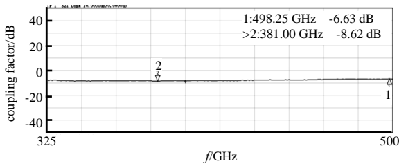
Fig.6 Coupling factor vs. frequency 图 6 耦合度测试曲线
