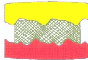
图9 靠密封圈表面的塑性变形，补偿法兰表面的凸凹不平和缺陷实现密封
