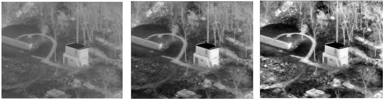
(a) 原始图像 (b) 全局直方图算法处理效果 (c) 本算法处理效果 (a) Original image (b) Effect of Global histogram (c) Effect of this algorithm
