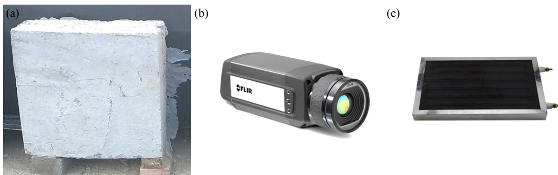
图2 实验试块和仪器:(a)混凝土试块;(b)红外热像仪;(c)红外加热板
