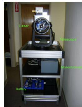
图 21 紫外拉曼光谱检测系统原理及实验原型
