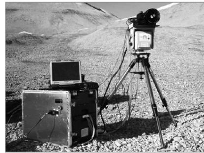
图7 远程便携式拉曼光谱仪结构及北极现场
