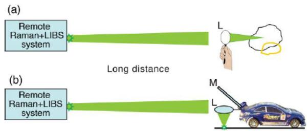
图 11 用于远程化学分析的双组分系统, 在目标附近使用了紧凑远程 Raman+LIBS 系统和远距聚焦透镜(L)。 (a)用于分析垂直表面目标和(b)结合折叠镜(M)用于分析地面化学品目标
