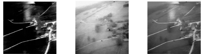
(a) 红外图像 (b) 可见光图像 (c) 加权平均融合图像 (a) Infrared image (b) Visible image (c) Weighted average fused image
