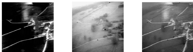
(a) 红外图像 (b) 可见光图像 (c) 小波变换图像融合 (a) Infrared image (b) Visible image (c) WT image fusion
